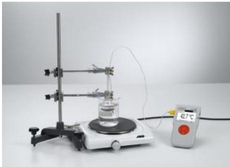
Au cours de l'expérience P2.1.2.2, on détermine le coefficient de dilatation cubique de l'eau et de l'éthanol à l'aide d'un dilatomètre volumétrique en verre.
