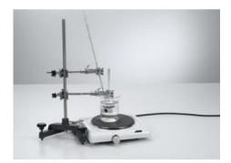
P2.1.2.1 Détermination du coefficient de dilatation cubique des liquides
