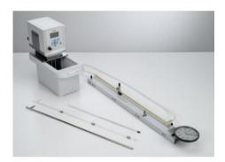
P2.1.1.3 Mesure de la dilatation linéaire des corps solides en fonction de la température
