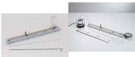
Permet la mesure exacte du coefficient de dilatation linéaire des solides en fonction du matériau, de leur longueur et de la température.
