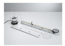
P2.1.1.2 Dilatation thermique des solides - mesure avec le pyromètre à cadran
