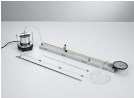
Durant la expérience P2.1.1.2, on mesure à laide dun pyromètre à cadran lallongement de différents tubes au passage de la température ambiante à la température de la vapeur.
