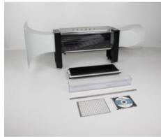
Veine d'essais fermée à parois latérales transparentes et plaque de fond interchangeable pour des expériences quantitatives en aérodynamique et en physique du vol avec le ventilateur aspirant/refoulant ( 37304 ).
