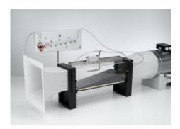
P1.8.7.3 Vérification de l'équation de Bernoulli -Mesure avec le manomètre de précision
