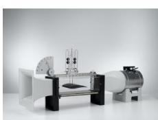
Au cours de l'expérience P1.8.7.1, on mesure la traînée aérodynamique FW et la poussée verticale FA d'une surface portante en fonction de l'angle d'attaque à de l'aile par rapport à la direction du courant.
