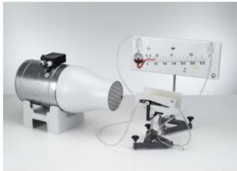
L'objet des expériences P1.8.6.3 et P1.8.6.6 est la mesure de la pression statique  $p$  à plusieurs points de la face supérieure et de la face inférieure d'un profil d'aile.
