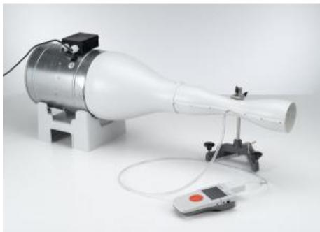
Pour vérifier les deux équations, on mesure au cours d'expérience P1.8.5.4 la pression statique dans un tube Venturi à des sections différentes.
