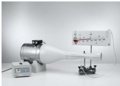
Pour vérifier les deux équations, on mesure au cours d'expérience P1.8.5.1 la pression statique dans un tube Venturi à des sections différentes.
