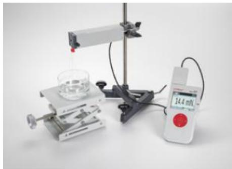
Au cours des expériences P1.8.4.1 et P1.8.4.2, on détermine la tension superficielle de l'eau et de l'éthanol.
