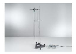
P1.8.3.1 Construction d'un viscosimètre à chute de bille pour déterminer la viscosité de liquides visqueux
