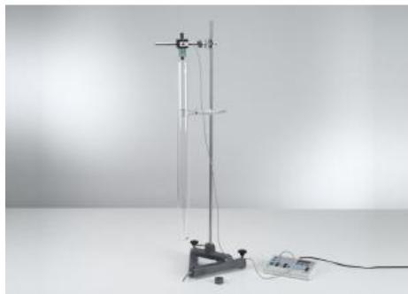
L'objet de l'expérience P1.8.3.1 est la construction d'un viscosimètre à chute de bille puis l'étude de la méthode de mesure sur l'exemple de la viscosité de la glycérine.
