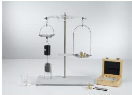
Le principe d'Archimède est vérifié expérimentalement au cours de l' expérience P1.8.2.1.
