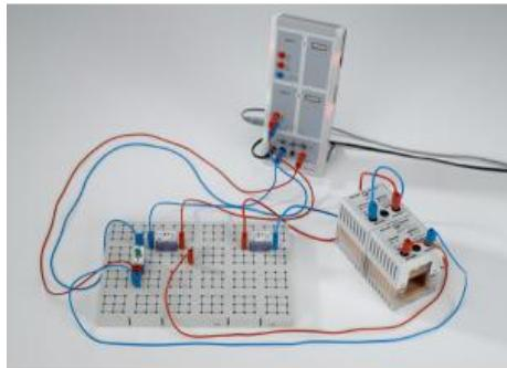
L'expérience P1.7.7.3 consiste à faire la comparaison entre le spectre fréquentiel de circuits électriques oscillants couplés et le spectre d'un circuit oscillant non couplé.
