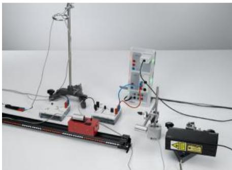
Durant l'expérience P1.7.6.2, deux transducteurs d'ultrasons servent soit démetteur soit de récepteur. Un transducteur est fixé sur un chariot à entraînement électrique alors que le second transducteur repose sur la table de laboratoire.
