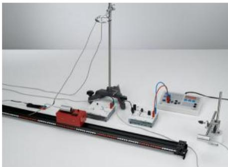
Durant l'expérience P1.7.6.1, deux transducteurs d'ultrasons servent soit démetteur soit de récepteur. Un transducteur est fixé sur un chariot à entraînement électrique alors que le second transducteur repose sur la table de laboratoire.
