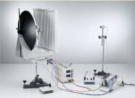
Pour les expériences P1.7.5.3 et P1.7.5.4, on place un transducteur considéré comme source ponctuelle dans le foyer d'un miroir concave. Les ondes ultrasonores planes ainsi produites subissent une diffraction par une fente simple, une fente double puis par des fentes multiples.
