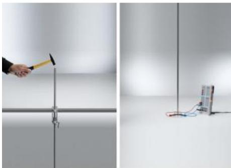
L'expérience P1.7.3.5 consiste à déterminer la vitesse du son dans des baguettes en aluminium, en cuivre, en laiton et en acier.
