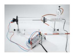
Au cours de l'expérience P1.7.3.4, on détermine la vitesse c du son dans le dioxyde de carbone et dans les gaz rares hélium et néon.
