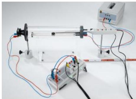
Dans l'expérience P1.7.3.3, on mesure la vitesse  $c$  du son dans l'air en fonction de la température puis on la compare avec la fonction linéaire
