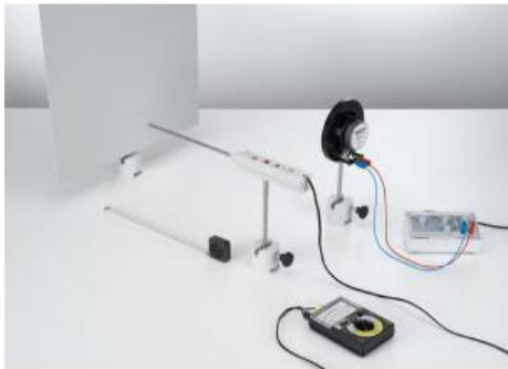
Au cours de l'expérience P1.7.3.2, des ondes stationnaires apparaissent par réflexion sur une paroi. Pour cela, des ondes sonores sont produites dans l'ensemble du domaine audible par un générateur de fonctions et un haut-parleur.
