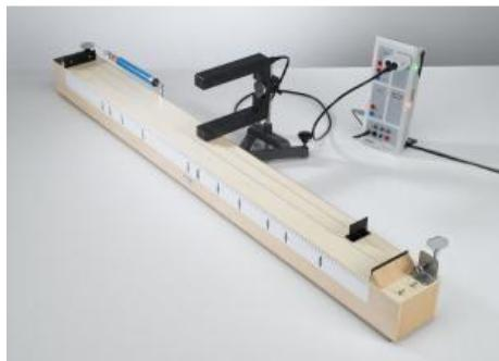
Au cours de l'expérience P1.7.2.1, on détermine la fréquence de vibration de la corde en fonction de sa longueur et de sa tension.
