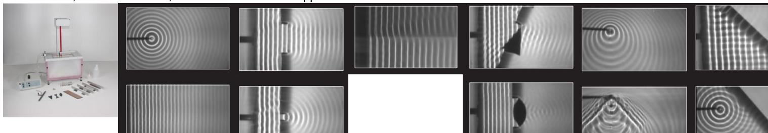
Pour illustrer la propagation des ondes, la réflexion, la diffraction, les interférences, la réfraction et l'effet Doppler sur l'exemple des ondes à la surface de l'eau.
