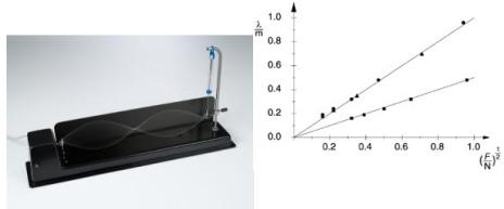
Au cours de l' expérience P1.6.3.1, on détermine, pour une fréquence d'excitation fixée, les longueurs d'onde en des ondes stationnaires pour différentes longueurs de corde  $s$  et différentes masses de corde  $m$ .
