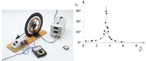
Au cours de l'expérience P1.5.3.2, le pendule de torsion est amené à des oscillations de fréquence  $\omega$  par un moment de torsion variant harmoniquement.
