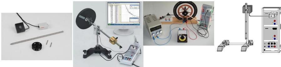
Pour la mesure sans frottement de mouvements de rotation, de déplacements linéaires, d'amplitudes, de périodes et de fréquences de rotation avec le Sensor-CASSY ( 524013 ), le Pocket-CASSY ( 524006 , 524018 ) ou l'Instrument de mesure universel Physique ( 531835 ).
