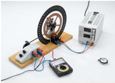
Au cours de l' expérience P1.5.3.2, le pendule de torsion est amené à des oscillations de fréquence  $\omega$  par un moment de torsion variant harmoniquement.
