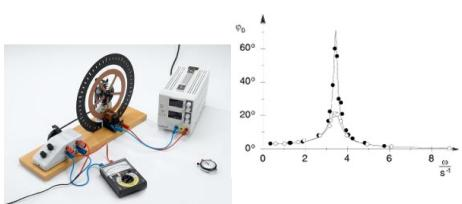
Au cours de l' expérience P1.5.3.2, le pendule de torsion est amené à des oscillations de fréquence  $\omega$  par un moment de torsion variant harmoniquement.
