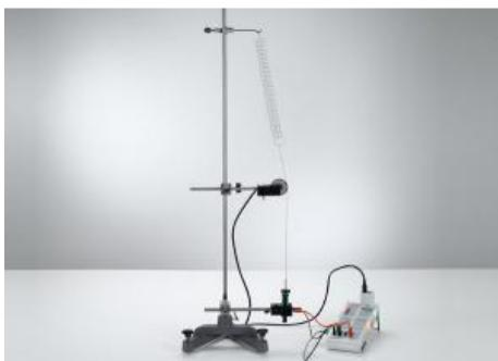
**P1.5.2.1 Oscillations d'un pendule à ressort et détermination de la période d'oscillation d'un pendule à ressort en fonction de la masse oscillante - Mesure avec CASSY**
