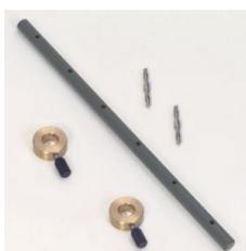
Tige ronde avec deux masses déplaçables pour l'étude des oscillations d'un pendule composé ou d'un pendule réversible à l'aide d'un capteur de rotation S ( 524 082 ).
