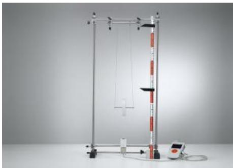
Dans l'expérience P1.4.6.2, on étudie la conservation de l'énergie à l'aide de la roue de Maxwell. Un capteur à ultrasons mesure la position et la vitesse de la roue, ce qui permet de calculer l'énergie cinétique.
