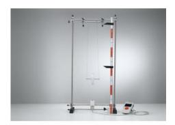
P1.4.6.2 Roue de Maxwell - tracé et évaluation avec
