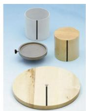
Pour déterminer expérimentalement les moments d'inertie.
