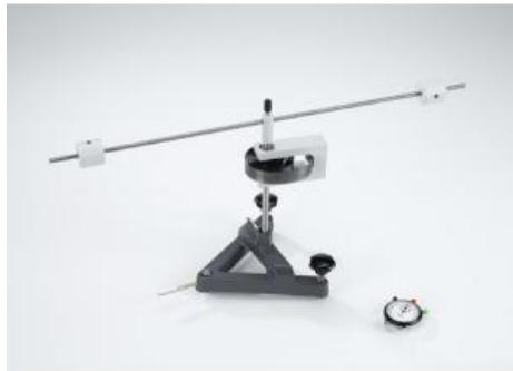
L'expérience P1.4.5.1 consiste à déterminer le moment d'inertie d'une masse ponctuelle en fonction de l'écart  $r$  à l'axe de rotation.
