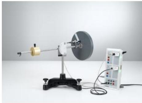
L'objet de l'expérience P1.4.4.3 est l'analyse de la précession d'un gyroscope.
