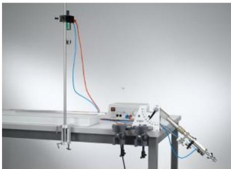
Dans l' expérience P1.3.6.2, une deuxième bille est mise en contact avec un aimant de maintien de telle sorte que la première la touche avec un mouvement à vitesse constante suivant la direction de tir.
