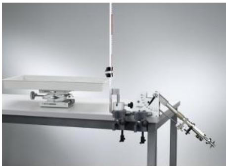
Au cours de l'expérience P1.3.6.1, la courbe de vol de la bille dacier est mesurée point par point avec une règle verticale.
