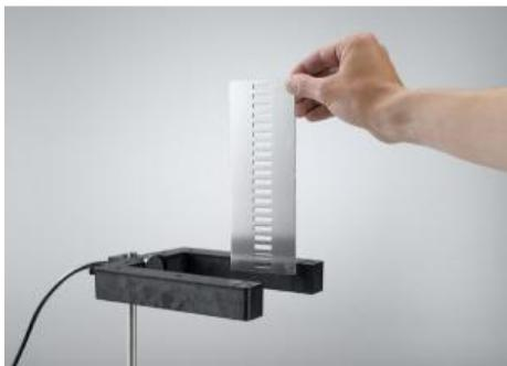
Dans l'expérience P1.3.5.3, une échelle à plusieurs échelons passe devant une barrière lumineuse en U branchée à l'interface CASSY pour ainsi pouvoir mesurer les temps d'obscurcissement. La mesure est équivalente à une mesure pour laquelle un corps tombe en passant devant plusieurs barrières lumineuses équidistantes.
