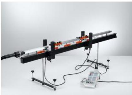
Durant l'expérience P1.3.4.8, on mesure le temps  $t_1$  durant lequel les faisceaux de deux barrières lumineuses sont interrompus.
