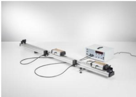
Durant l'expérience P1.3.4.6, on mesure le temps  $t_1$  durant lequel les faisceaux de deux barrières lumineuses sont interrompus par deux mobiles placés sur le rail à chariot, avant ou après un choc élastique ou inélastique. On étudie aussi bien les chocs entre un mobile en mouvement et un objet au repos que ceux entre deux mobiles en mouvement.
