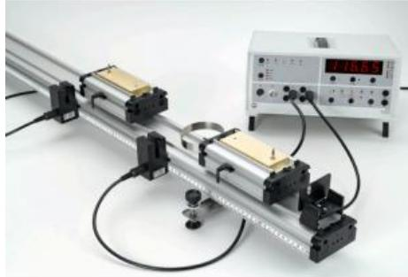
Durant l'expérience P1.3.4.1, on mesure le temps  $t_1$  durant lequel les faisceaux de deux barrières lumineuses sont interrompus par deux mobiles placés sur le rail à chariot, avant ou après un choc élastique ou inélastique.
