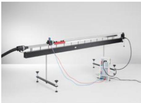
Les mouvements uniformes et uniformément accélérés sur le banc à coussin d'air en position horizontale font l'objet de l'expérience P1.3.3.4.
