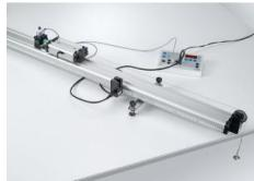
Durant l'expérience P1.3.2.1, une approche expérimentale de la définition de la vitesse  $v$  en tant que quotient de la différence de distance  $s$  par la différence de temps  $t$  correspondante est possible avec des moyens simples. La différence de distance  $s$  est relevée directement sur le rail à l'aide d'une règle graduée.
