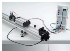
Dans l'expérience P1.3.2.2, on étudie l'évolution du mouvement du chariot sur le rail entraîné par un fil fin.
