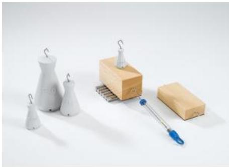
L'expérience P1.2.6.1 consiste à mettre tout d'abord en évidence que la force de frottement statique  $F_H$  et la force de frottement de glissement  $F_G$  ne dépendent pas de la taille de la surface portante et sont proportionnelles à la force d'appui  $G$  du support sur la base du bloc de frottement.
