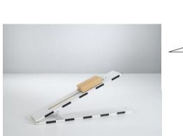
Dans l' expérience P1.2.5.2, on utilise le fait que la force normale dépende de l'angle d'inclinaison afin de déterminer quantitativement le coefficient de frottement statique  $\mu$  d'un corps.
