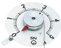
Avec poulie de renvoi à roulement à billes sur aimant, pour le tableau magnétique ( 301 301 ).
