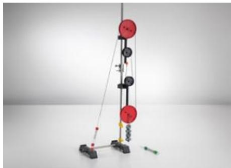
Dans l'expérience P1.2.4.1 consiste à monter le palan sur la table à laide d'une embase multifonctionnelle. Les roulements qui équipent les poulies diminuent considérablement les frottements.
