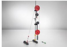
Dans l'expérience P1.2.4.1 consiste à monter le palan sur la table à laide d'une embase multifonctionnelle. Les roulements qui équipent les poulies diminuent considérablement les frottements.
