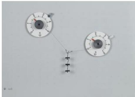
Durant l'expérience P1.2.2.1, une force  $F$  quelconque est compensée par l'élasticité de deux dynamomètres formant les angles  $\alpha_1$  et  $\alpha_2$  avec  $F$ .
