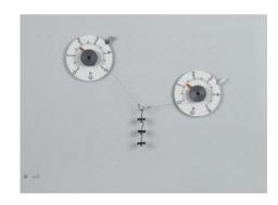
Durant lexpérience P1.2.2.1, une force F quelconque est compensée par lélasticité de deux dynamomètres formant les angles á1 et á2 avec F.
