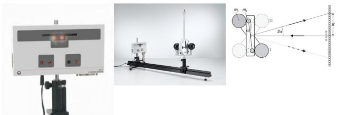
Appareil de mesure opto-électronique pour l'enregistrement des oscillations de balances de gravitation.
