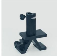
Cavalier pour banc d'optique à profil normalisé.
