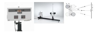
Appareil de mesure opto-électronique pour l'enregistrement des oscillations de balances de gravitation.
