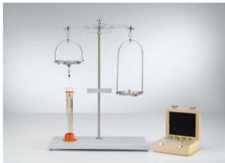
Pour mesurer la densité de liquides, on dispose du corps plongeur dans l' expérience P1.1.2.2. Il s'agit dans les deux cas de déterminer la densité de mélanges d'eau et d'éthanol. Avec le corps plongeur, la densité est déduite de la poussée verticale que subit un corps de volume connu dans le liquide étudié.
