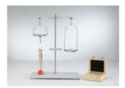
P1.1.2.2 Mesure de la densité des liquides avec corps plongeur
