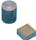
Pour des expériences sur la masse volumique et la capacité calorifique de différents matériaux.
