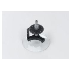
L'expérience P1.1.1.3 consiste à déterminer les rayons de courbure R de verres de montre à l'aide d'un sphéromètre.
