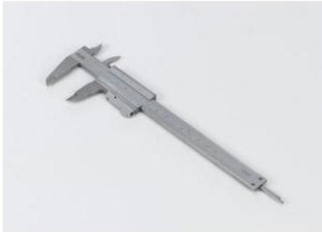
L'expérience P1.1.1.1 consiste à déterminer les dimensions extérieures et intérieures d'un objet à mesurer à l'aide d'un pied à coulisse.
